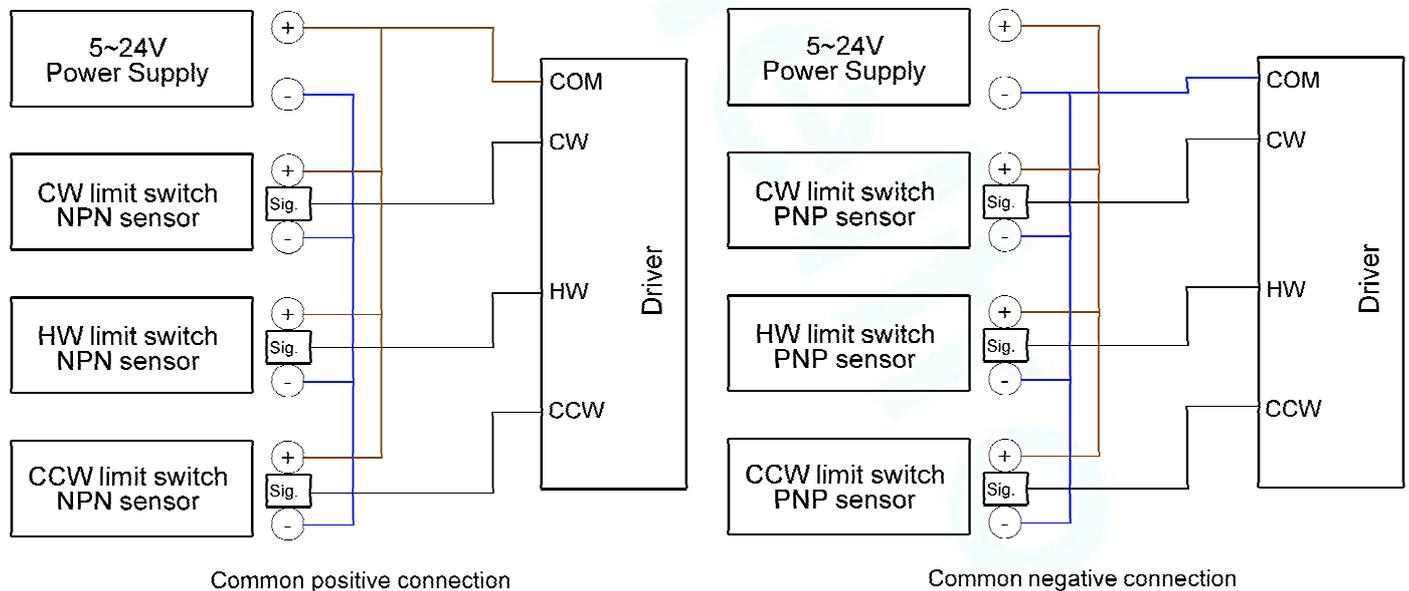
Gemeinsame Spannung (Common positive Connection) ist eine Schaltung bei der mehrere Komponenten ( hier NPN-Sensoren) sich eine gemeinsame Spannungszufuhr (hier +24V) teilen.
